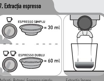
Portafiltrul trebuie să se afle în poziție centrală.
