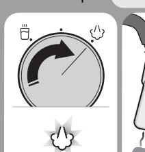
Când sunteți în poziție, rotiți cadrul înapoi în poziție ABUR pentru a începe texturarea laptei.
