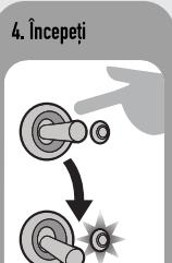
Conectați-l la priză. Deplasați comutatorul de alimentare în jos; comutatorul va reveni în centru. Lumina indicatoare va clăji în timpul încălzirii.
