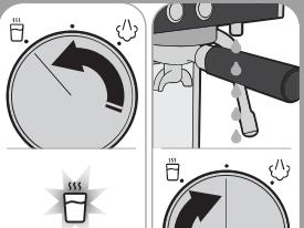
Rotiți selectorul pe APĂ CALDĂ, apă va fi distribuită de la robinetul de apă caldă. Reduceti cadrul în poziție verticală pentru a opri distribuirea.
