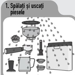
Spălați recipientul de lapte, filtrele, portafiltrul, recipientul de boabe, lama superioară, presa și rezervorul de apă în apă caldă, cu un detergent slab. Clătiți și lăsați să se usuce bine la aer.
